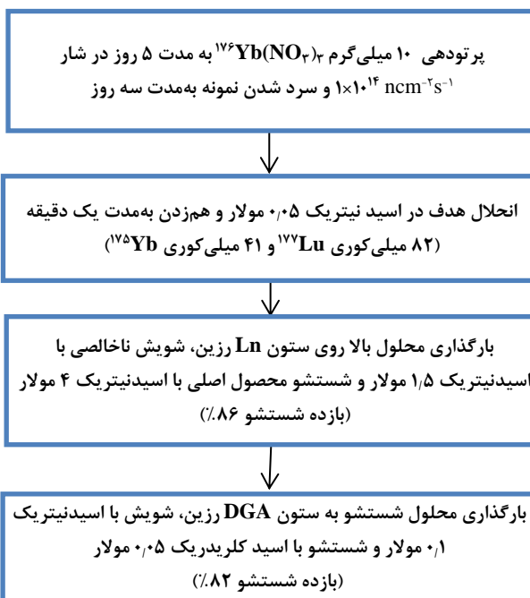
شکل ۱. فرایند جداسازی ایتربیم و لوتسیم با استفاده از روش کروماتوگرافی استخراجی.
