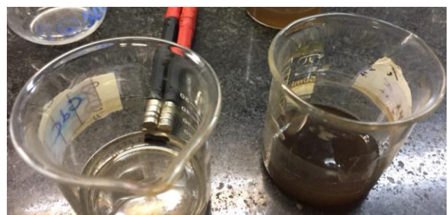
شکل ۱. سوسپانسیون نانوذرات مغناطیسی (شکل سمت راست) و نانوذرات جمع‌آوری شده توسط آهن‌ربا (شکل سمت چپ)
