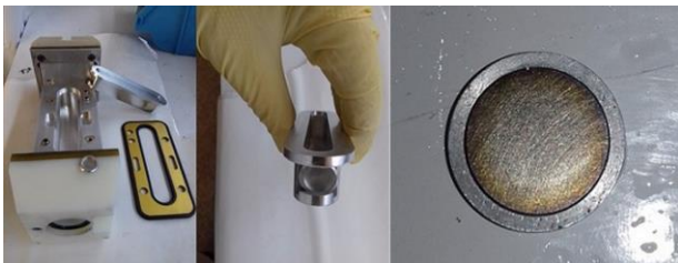
شکل ۱. شاتل و نگه‌دارنده و هدف تیتانیومی ساخته شده
