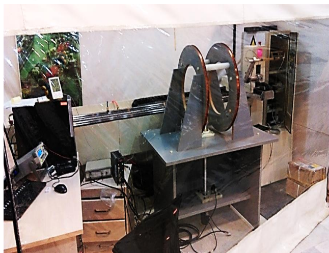
شکل ۱۳. اتاقک مخصوص اندازه‌گیری که مجهز به سیستم تهویه و کنترل دما است. دما به کمک یک دماسنج جیوه‌ای و یک دماسنج دیجیتال کنترل، و در هر اندازه‌گیری برای هر آهنربا ثبت شد.
