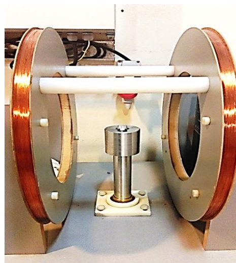
شکل ۸. نمایی کلی از پیچه‌ی هلمهولتز و محور دوران که دقیقاً مرکز هندسی آهنربا را در مرکز پیچه قرار می‌دهد.
