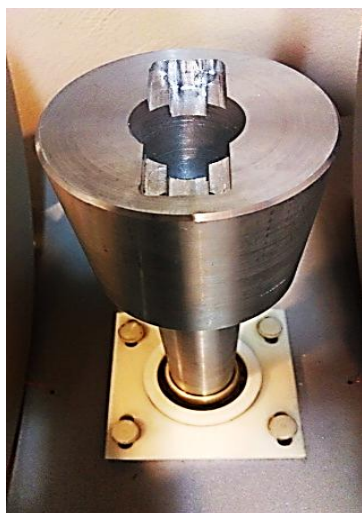
شکل ۶. قطعه‌ی آلومینیومی برای ثابت نگه داشتن آهنربا در دو سطح مختلف.
