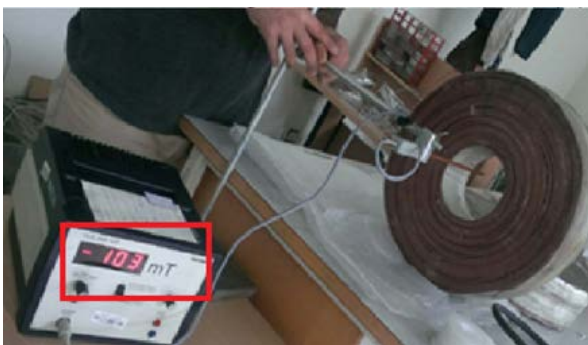
شکل ۸. نتایج شبیه‌سازی میدان مغناطیسی درون پیچه مسی با جریان ۵۵ آمپر (بالا). میدان مغناطیسی اندازه‌گیری شده، ۱۰۳ mT، در مرکز پیچه (پایین).
