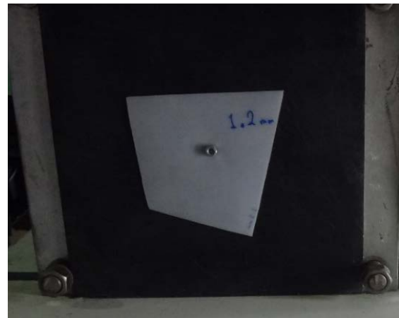
شکل ۵. فانتوم آزمون حساسیت کنتراست ایزوله در تصویربرداری ایکس بازگشتی.
