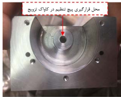
شکل ۳. محل قرارگیری پیچ‌های تنظیم کاواک شتاب‌دهی و تزویج.
