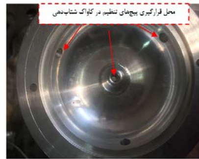
شکل ۳. محل قرارگیری پیچ‌های تنظیم کاواک شتاب‌دهی و تزویج.
