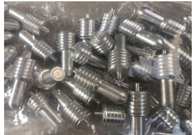
شکل ۴. پیچ‌های تنظیم نیم‌کاواک‌های شتاب‌دهی و کاواک تزویج.
