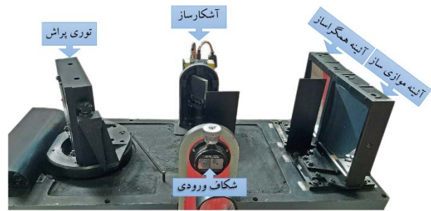
شکل ۱. نمایی از تکفام‌ساز توکامک دماوند (بدون سرپوش اصلی).
