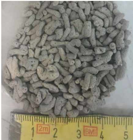
شکل ۴. گرانول‌های متخلخل تهیه‌شده از موردنیت.
