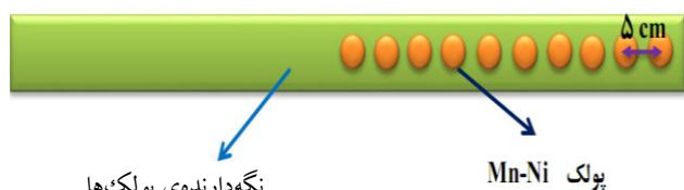
شکل ۱. نحوه‌ی چیدمان پولک‌های منگنز-نیکل برای اندازه‌گیری نسبت کادمیم در راستای محوری راکتور.
