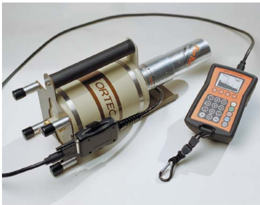
شکل ۲. آشکارساز ژرمانیم فوق‌خالص قابل‌حمل استفاده شده ساخت شرکت ORTEC.
