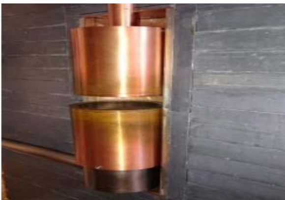
شکل ۱. چیدمان هم‌فرودی دو آشکارساز ژرمانیم فوق‌خالص با داده‌برداری لیست‌مد.
