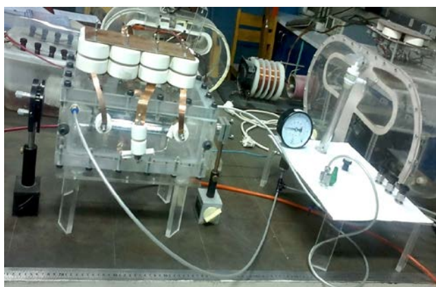
شکل ۲. تصویری از لیزر CO 2 پر فشار به کار رفته.
