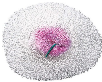
شکل ۱۱. نمایی از چشمه توری گازی حاوی ^{232}\text{Th} .
