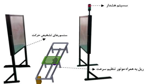
شکل ۵. شماتیکی از چینش آزمون پیشگر برای انجام آزمون سرعت چشمه‌های در حال عبور.
