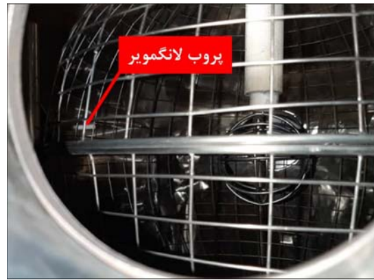
شکل ۶. پروب لانگمویر قرار گرفته بین دو الکترود هم‌مرکز آند و کاتد در دستگاه IR-IECF.
