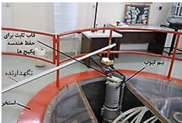
شکل ۱. پرتودهی دزیمترها در مقابل بیم‌تیوب حرارتی MNSR اصفهان بدون امکان استفاده از فانتوم.
