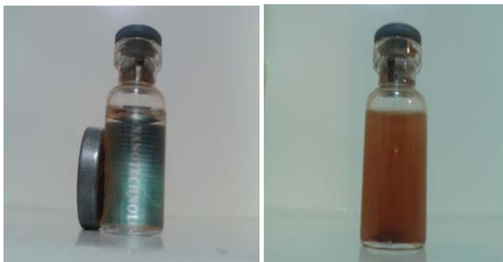
شکل ۴. منحنی VSM نانوذرات \text{Fe}_3\text{O}_4 /HAP با نسبت وزنی مختلف (۱:۱)، (۱:۲)، (۱:۳) و (۱:۵) و پاسخ آن‌ها در محلول به میدان مغناطیسی خارجی.
