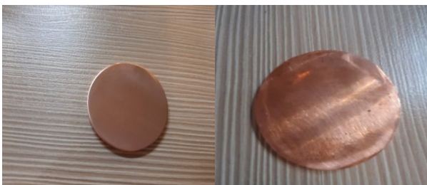
شکل ۱۱. پولک‌های مسی را قبل و بعد از عملیات پرداخت و صیقلی کردن.
