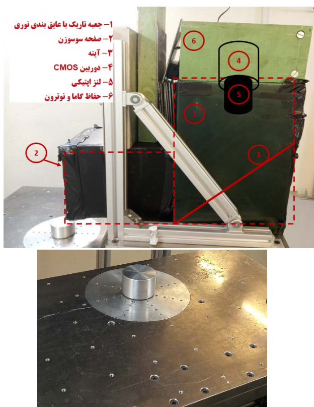
شکل ۱. سیستم تصویربرداری دیجیتال به روش پریسکوپي (بالا)، میز قرارگیری نمونه برای تصویربرداری مقطع‌نگاری نوترونی (پایین).
