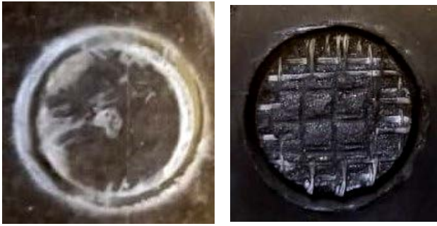
شکل ۱. تصاویر دیجیتال از منطقه جدایش پوشش‌های مختلف اعمال شده روی سطح زیرلایه.
