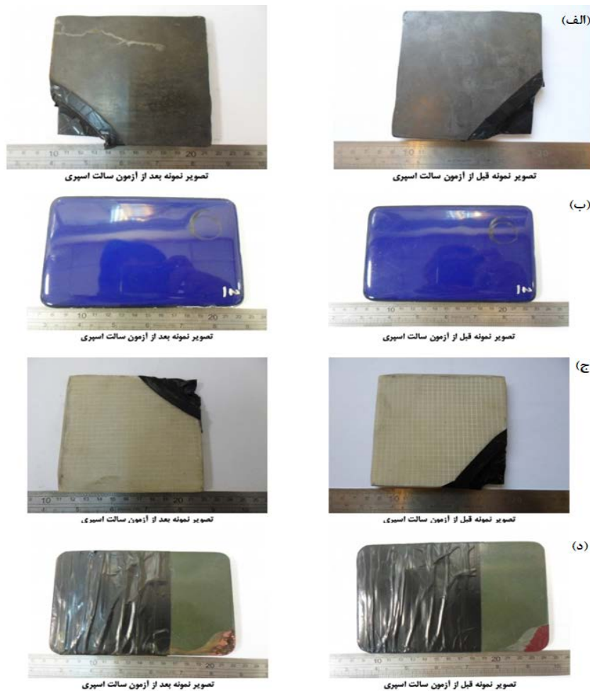
شکل ۲. تصویر قبل و بعد از آزمون پاشش مه نمکی نمونه‌های (الف) پوشش آستری گرافیت، (ب) پوشش آستری شیشه، (ج) پوشش آستری سرامیک-پلیمر و (د) پوشش اتیلن کلروتری فلوروواتیلن.
