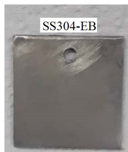
شکل ۶. تصاویر و نتایج EDAX نمونه SS304 بعد از آزمون خوردگی در الکترولیت حاوی باکتری (در تصاویر SEM اندازه درجه بندی ۲ میکرومتر).
