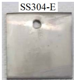
شکل ۵. تصاویر و نتایج EDAX نمونه SS۳۰۴ بعد از آزمون خوردگی در الکترولیت بدون باکتری (در تصاویر SEM اندازه درجه‌بندی ۲ میکرومتر).
