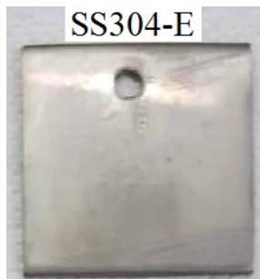
شکل ۵. تصاویر و نتایج EDAX نمونه SS۳۰۴ بعد از آزمون خوردگی در الکترولیت بدون باکتری (در تصاویر SEM اندازه درجه‌بندی ۲ میکرومتر).
