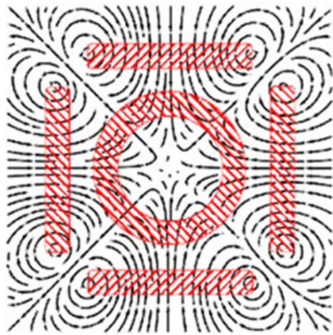
شکل ۴. شمایی از میدان مغناطیسی یک پلی‌ول [۱۲].
