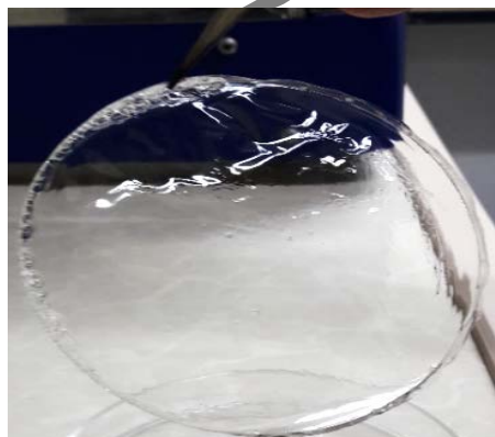
شکل ۲) نمونه‌ای از فیلم فیبروین ابریشم (EDX)
