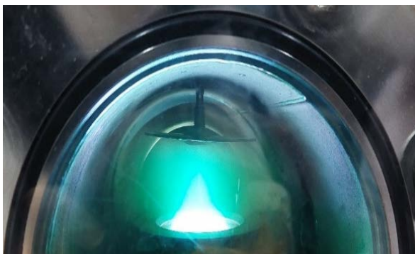
شکل ۵) سیستم کند و پاش مغناطیسی
