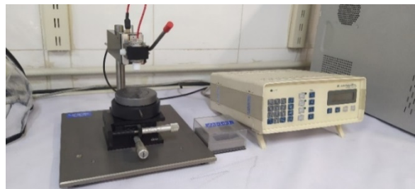
شکل ۳) سیستم آنالیز پروب چهار نقطه‌ای
