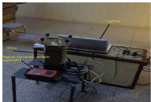
شکل ۱. چیدمان آشکارساز HPGe استفاده شده در اتاق درمان.
