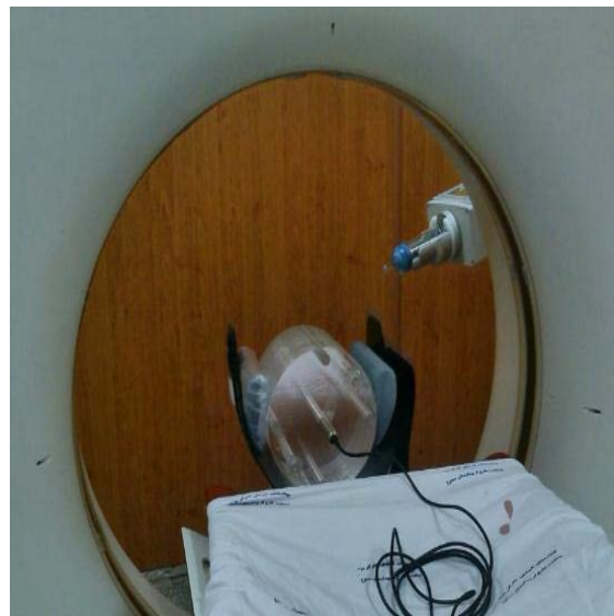
شکل ۱. فانتوم CTDI و نحوه قرار دادن آن در دستگاه سی‌تی‌اسکن.
