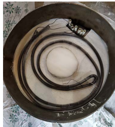
شکل ۱۱. نحوه قرارگیری المنت حرارتی در قسمت انتهایی محفظه.
