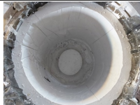
شکل ۱۰. بدنه داخلی رآکتور با عایق آلومینا.
