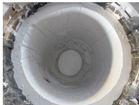
شکل ۱۰. بدنه داخلی رآکتور با عایق آلومینا.
