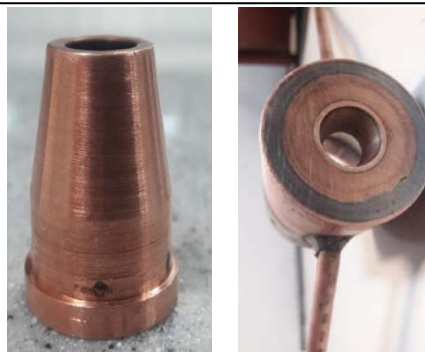
شکل ۹. ساخت آند (الف) و نازل (ب).
