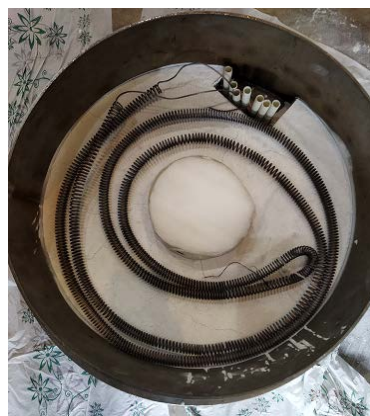
شکل ۱۱. نحوه قرارگیری المنت حرارتی در قسمت انتهای محفظه.
