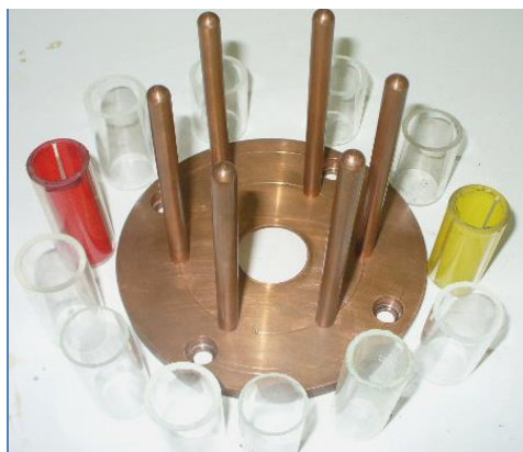
شکل ۳. ابعاد و هندسه‌ی مخروطی نوک الکتروند دستگاه پلاسمای کانونی و تصویر برخی از عایق‌های مورد استفاده در این مطالعه.
