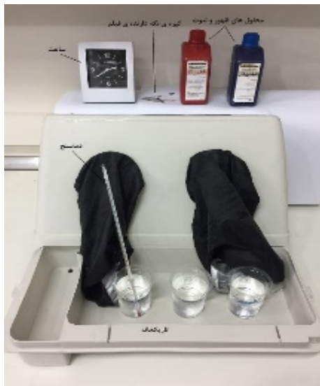
شکل ۴. تاریک‌خانه به همراه محلول‌های ظهور و ثبوت (شرکت طیف‌پرداز) و سایر تجهیزات پردازش فیلم.
