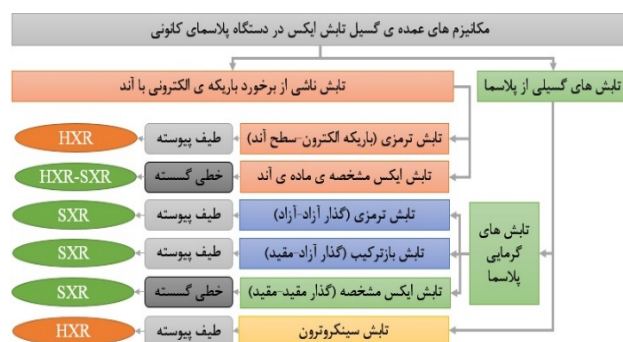
شکل ۱. دسته‌بندی مکانیسم‌های عمده‌ی گسیل تابش ایکس در دستگاه پلاسمای کانونی [۱].
