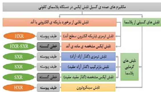
شکل ۱. دسته بندی مکانیسم های عمده ی گسیل تابش ایکس در دستگاه پلاسمای کانونی [۱]
