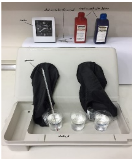
شکل ۴. تاریک‌خانه به همراه محلول‌های ظهور و تثبیت (شرکت طیف‌پرداز) و سایر تجهیزات پردازش فیلم.
