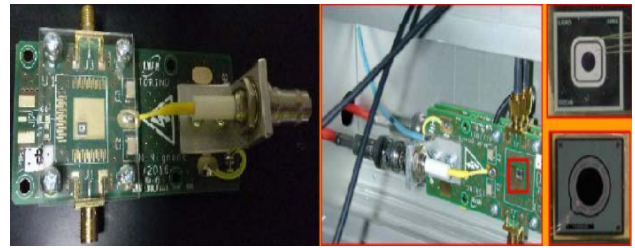
شکل ۲. یک جفت برد آشکارساز سیلیکونی فوق سریع ( 1\text{ mm}^2 \times 50\ \mu\text{m} ).
