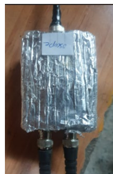
شکل ۲. شماتیک مدار مربوط به راه‌اندازی آشکارساز فوتو دیود BPX۶۵ و نمونه قرار گرفته مدار در جعبه آلومینیومی.
