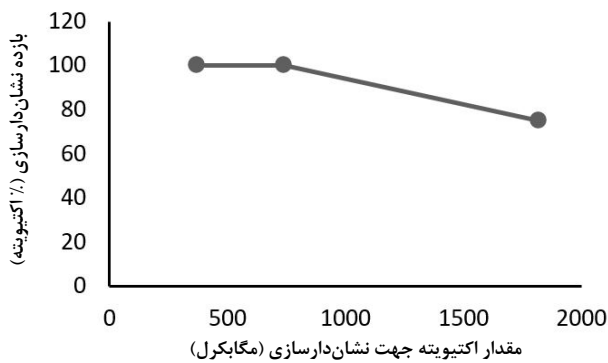
شکل ۲ بررسی بازده نشان‌داری ذرات حاوی مقدار ۱۰۰ میکروگرم کلرید قلع و نشان‌دار شده با مقادیر مختلف اکتیویته شامل: ۳۷۰، ۷۴۰ و ۱۸۳۰ مگابکرل.
