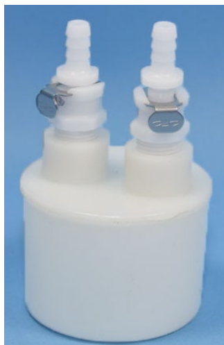
شکل ۲. محفظه اندازه‌گیری رادیوزنون به همراه شیرهای ورودی و خروجی گاز.
