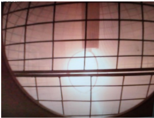
شکل ۸. کارکرد الکتروود جدید در دستگاه IR-IECF و تشکیل پلاسمای دوتریم در ولتاژ ۲۰ کیلو ولت و جریان ۳۰ میلی آمپر.
