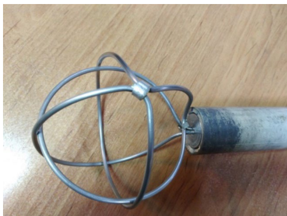
شکل ۷. الکتروود کاند و محل اتصال با ورودی و ولتاژ بالا.
