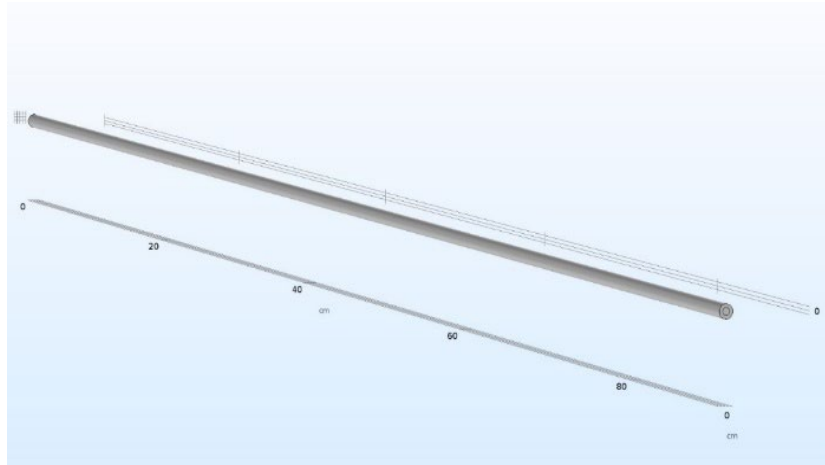
شکل ۲. نمایی از لوله طراحی شده در نرم افزار که مرکز آن آب و پوسته آن از جنس استیل در نظر گرفته شده است.
