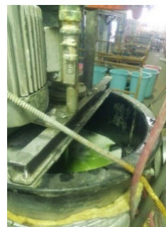
شکل ۱۱. انجام فرایند استخراج حلالی اورانیم از اسید فسفریک در مقیاس پایلوت.
