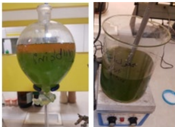
شکل ۲. فرایند اختلاط و جداسازی دو فاز.
