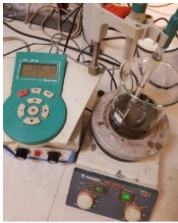
شکل ۳. تنظیم پتانسیل محلول استریپ با آهن اسفنجی.
