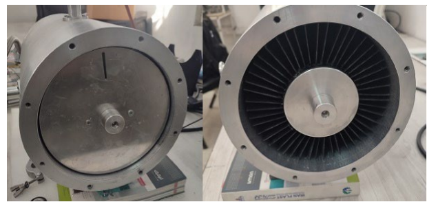
شکل ۱۳. نصب دیسک برشگر بر روی دستگاه گزینشگر سرعت نوترون.
