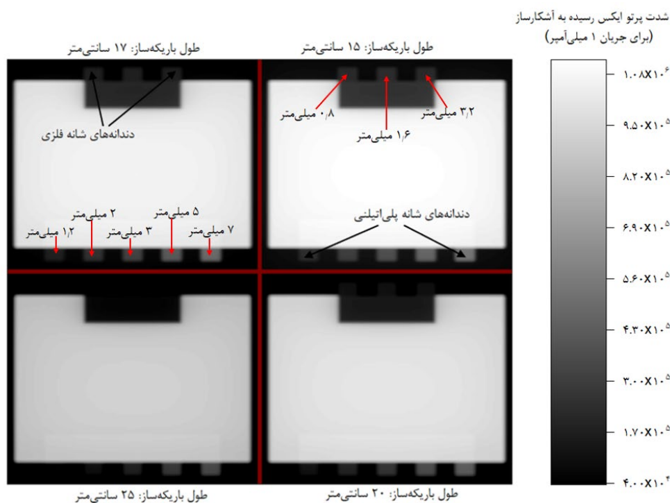
شکل ۲۰. تصویر شبیه سازی شده برای جسم آزمون شناسایی مواد در هوا براساس مقادیر مختلف طول باریکه سازه و عرض شکاف ۱ میلی متر.
