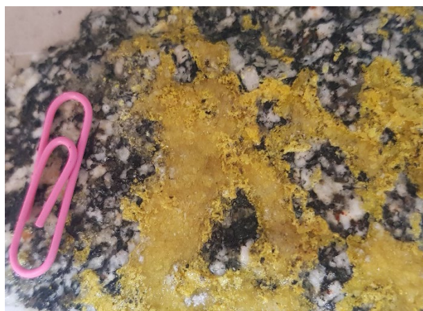
شکل ۲. نمای از تشکیل کانی‌های سیلیکات اورانیل زرد رنگ در سطح شکستگی‌های گنیس در بلوک ۱ محدوده ۶ خشومی.
