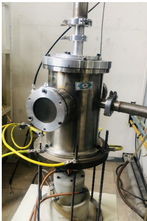
شکل ۲. نمای از چیدمان آزمایشگاهی دستگاه پلاسمای کانونی مدر MTPF2.4kJ .
