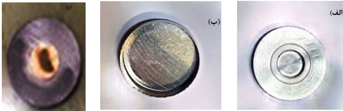
شکل ۲. (الف) قرص آلومینیومی، (ب) پوشش آلومینیومی با خلوص بالا و (ج) هدف باریمی فشرده شده.
