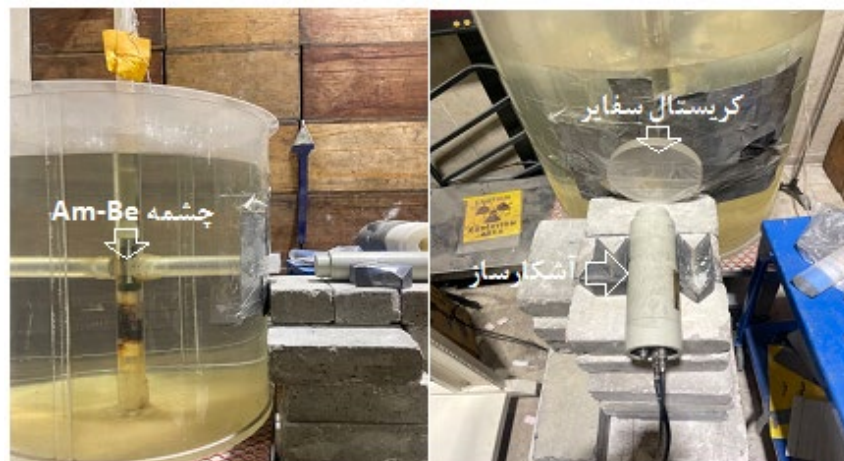
شکل ۲. چیدمان آزمایش اندازه‌گیری تغییرات شدت نوترون سریع با حضور کریستال سفایر فیلتر نوترون سریع در مسیر باریکه نوترون خروجی از یک چشمه Am-Be.
