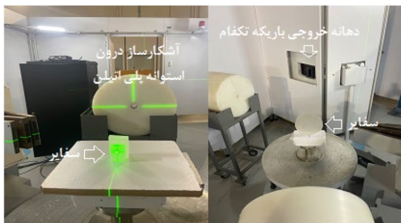
شکل ۳. چیدمان آزمایش اندازه‌گیری تغییرات شدت نوترون حرارتی با حضور کریستال سفاير در مسیر باریکه نوترون مونوکروماتیک خروجی از سامانه کانال D رآکتور تحقیقاتی تهران.
