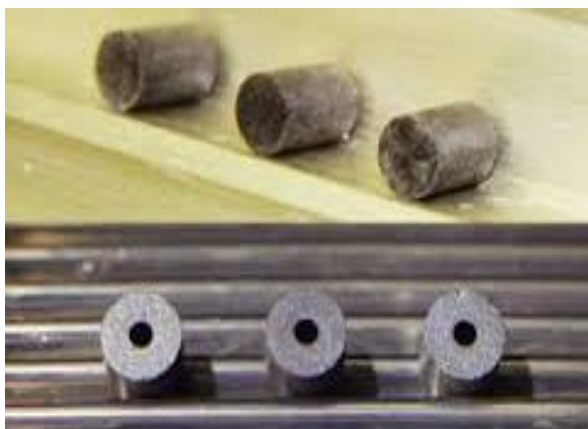
شکل ۱. نمونه‌ی قرص‌های توپر و حلقوی سوخت هسته‌ای.
