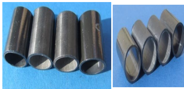
شکل ۴. تصویر نمونه‌های تحت آزمون خوردگی در اتوکلاو قرار گرفته: از راست به چپ: نمونه‌ی ۱. اسیدشویی و آندی شده (AA)، ۲. سنباده خورده و آندی شده (PA)، ۳. سنباده خورده (P) و ۴. اسیدشویی شده (A) از زاویه‌های مختلف.
