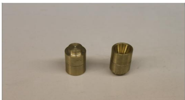
شکل ۳. استفاده از روزنه‌ی سوزنی ۵۰۰ میکرون برای جلوگیری از برخورد زیاد یون‌ها به آشکارساز.
