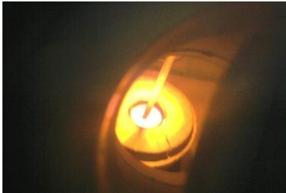
شکل ۳. طرح‌واره‌ی دستگاه رشد بلور چکرالسکی و تجهیزات جانبی آن در زمان رشد بلور BaCl_2 .
