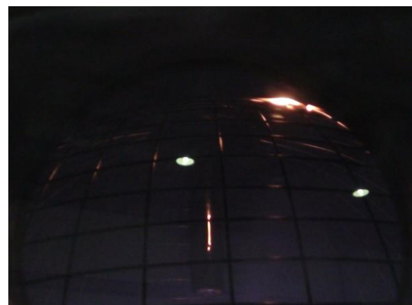
شکل ۶. ذوب شدن قسمت کوچکی از کره‌ی بیرونی در اثر برخورد جت الکترونی و تبدیل آن به تفنگ الکترونی.
