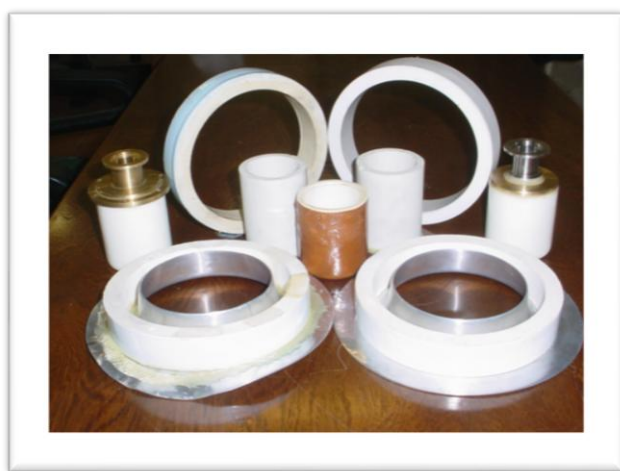
شکل ۶. نمونه‌ای از سرامیک‌های مورد استفاده در ساخت ستون شتاب‌دهنده‌ی ۱۵۰kV.
