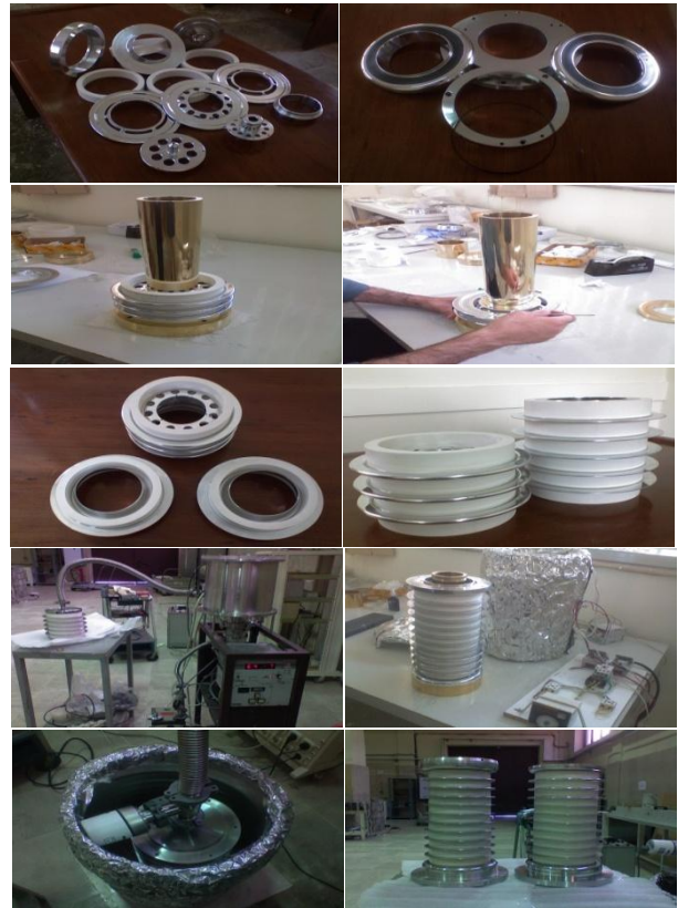
شکل ۷. مراحل مختلف اتصال قطعات و آزمایش ستون شتاب‌دهنده.
